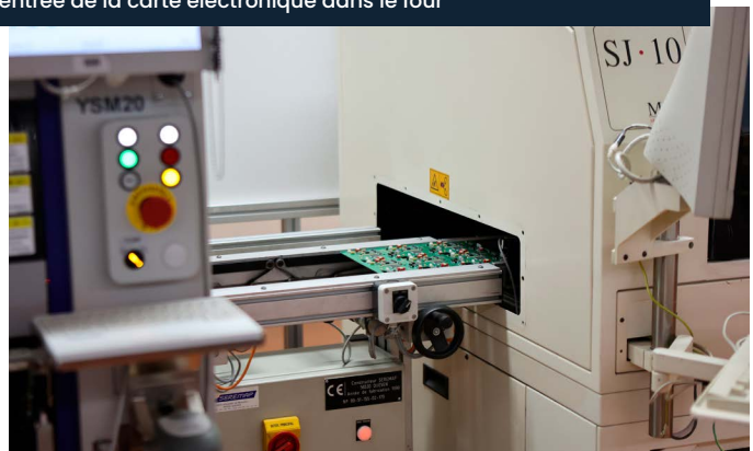
Détail d'une ligne CMS de production automatisée, dernière étape... l'entrée de la carte électronique dans le four
